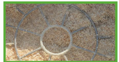
Der Mischer im Materialtrichter verhindert „Brückenbildung“ bei leichten Materialien und sortiert mit starken Magneten größtenteils Fremdkörper wie Nägel oder Metallspäne aus.
