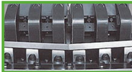
Die Mühlen der Schneidmühle können je nach Aufgabenstellung mit verschiedenen Rotortypen ausgestattet werden. Die Rotormesser sind nach neuester V-Schnitt-Technologie angeordnet, die stets für ein hochwertiges Mahlgut sorgt
