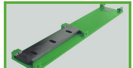
Die Messer können mithilfe der im Lieferumfang enthaltenen Einstelllehre außerhalb der Schneidmühle justiert werden, was komplizierte Einstellarbeiten innerhalb der Maschine überflüssig macht.
