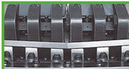
Die Schneidmühle kann je nach Aufgabenstellung mit verschiedenen Rotortypen ausgestattet werden. Die Rotormesser sind nach der neuesten V-Schnitt-Technologie angeordnet, die für stets hochwertiges Mahlgut sorgt.
