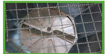
Le mélangeur situé dans la trémie empêche la formation potentielle de voûtes pouvant venir de matériaux très légers. De plus, le mélangeur est équipé de puissants aimants intégrés capables de trier les corps étrangers tels que les clous ou la limaille.
