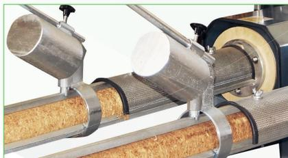
Durch die Positionierung der Stellklammern wird der Härtegrad der finalen Taler oder Briquets festgelegt.
