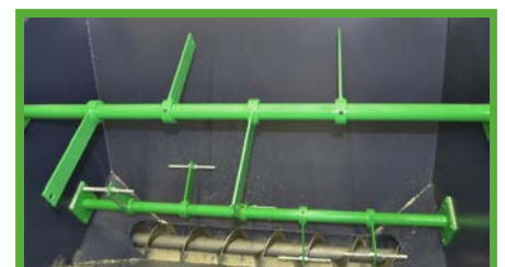
Outils de mélange intégrés pour éviter la formation de voûtes lorsque la matière est très légère
