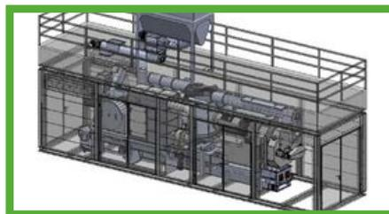
Le périmètre de production mobile en conteneur est constitué d'une construction en acier massive avec des éléments isolés et climatisés.
