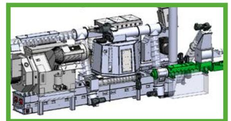
L'EPF-M est une ligne de granulation en circuit fermé dans laquelle la matière est d'abord réduite par affinage, humidifiée, granulée et enfin criblée et refroidie.
