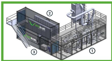
Toute l'unité Ecokraft Factory est montée sur 3 conteneurs mobiles qui résistent aux intempéries: 1. Unité de granulation, 2. Armoire électrique & 3. Salle de contrôle
