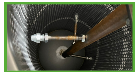
Abreinigbare Dauerfilterpatrone für geringe Verschleißkosten
