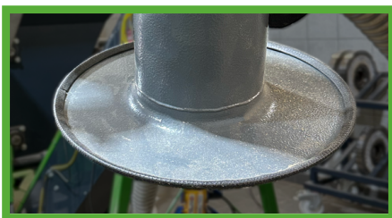
Punktabsaugung mit mind. 10 - 15 cm Abstand zur Staubquelle
